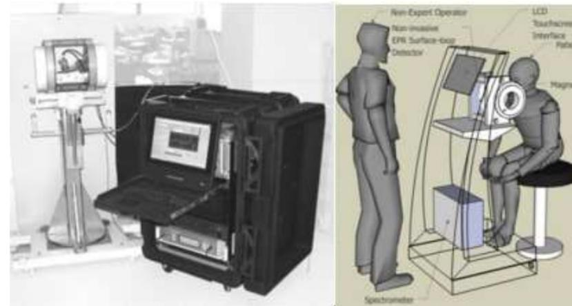
Spettrometro EPR trasportabile e compatto per la misura *in vivo* in situ
